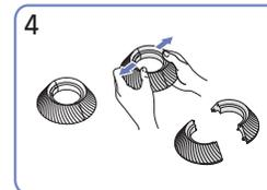
4 Disassemble the COVER-REAR TOP.
