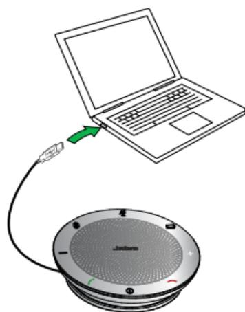
Conecte el cable USB del Jabra Speak 510 a cualquier puerto USB disponible de su ordenador para así cargar la batería. La luz de la batería se ilumina en color rojo mientras se está cargando, y en color verde (1 minuto) cuando está totalmente cargada.
